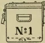
Zwei Schlofsbänder sind anzubringen, welche etwas geklemmt in die Ösen passen, um einen guten Verschluss herbeizuführen. Der Zinkeinsatz kann auch durch einen Weißblecheinsatz ersetzt werden. Er ist oben bei *a* umgebogen zum Auflöten des Deckels, welcher unten auf dem Boden liegt. Zum provisorischen Dichten empfiehlt es sich vielleicht, Kautschukreifen unterzulegen.
